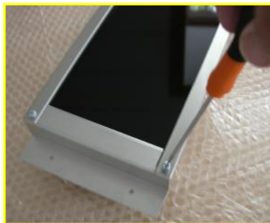
Anschrauben der Montagewinkel
