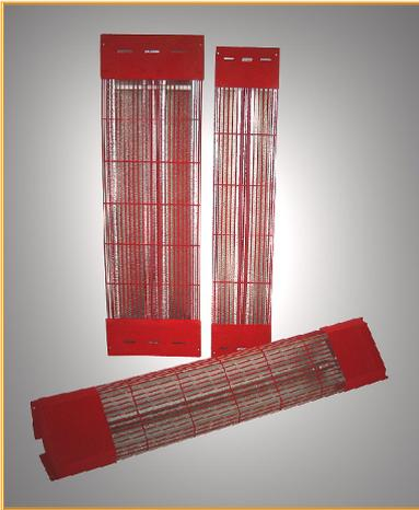
Die **INFRAMAGIC® U-Rohr-Incolloy-Magnesiumoxydstrahler** bestehen aus einem U-förmig-gebogenen Edelstahl (Incolloy) Metallrohr, in dem sich eine Magnesiumoxydfüllung mit einem darin mittig verlaufenden Heizdraht befindet.
